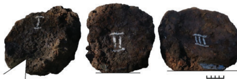
Рис. 2. Общий вид криц и линии их рассечения Fig. 2. General view of the blooms and their cutting lines
