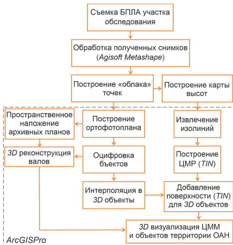
Рис. 6. Алгоритм построения цифровой модели рельефа местности и 3D визуализации объектов, находящихся на территории археологического памятника
