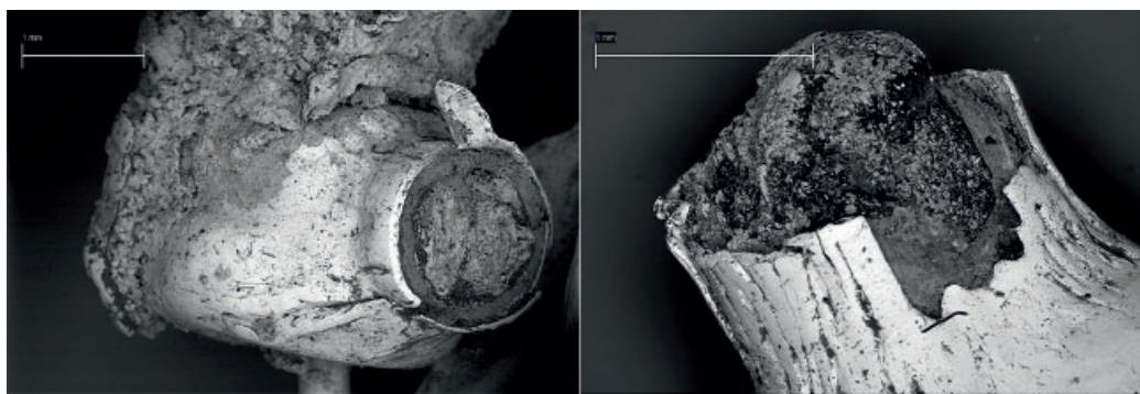
Рис. 11. Микрофотографии слома подвесок 1 и 2 украшения с бирюзой (ГЭ. Инв.№ 2520/18) по краю золотого листа обтяжки. Изображение в обратно-рассеянных электронах до реставрации.
