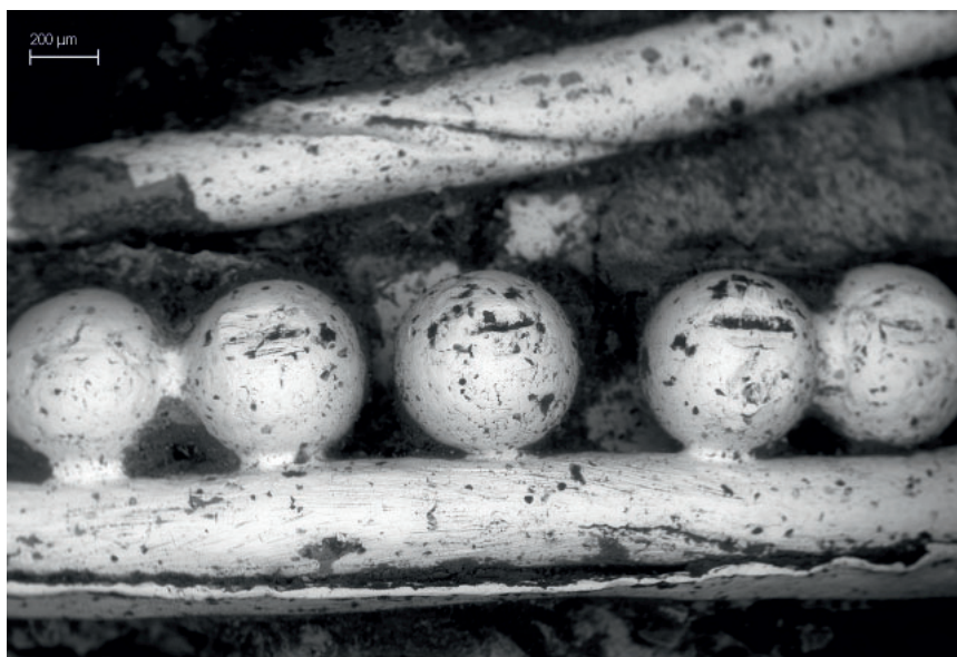
Рис. 22. Деталь В «фрагментов щитковидных серег» (ГЭ. Инв. № 2520/8). Зернь, проволока, пайка. Изображение в обратнорассеянных электронах. Fig. 22. Detail B of 'shield-shaped earring fragments' (SHM. Inv. No. 2520/8). Granulation, wire, soldering. BSE image.
